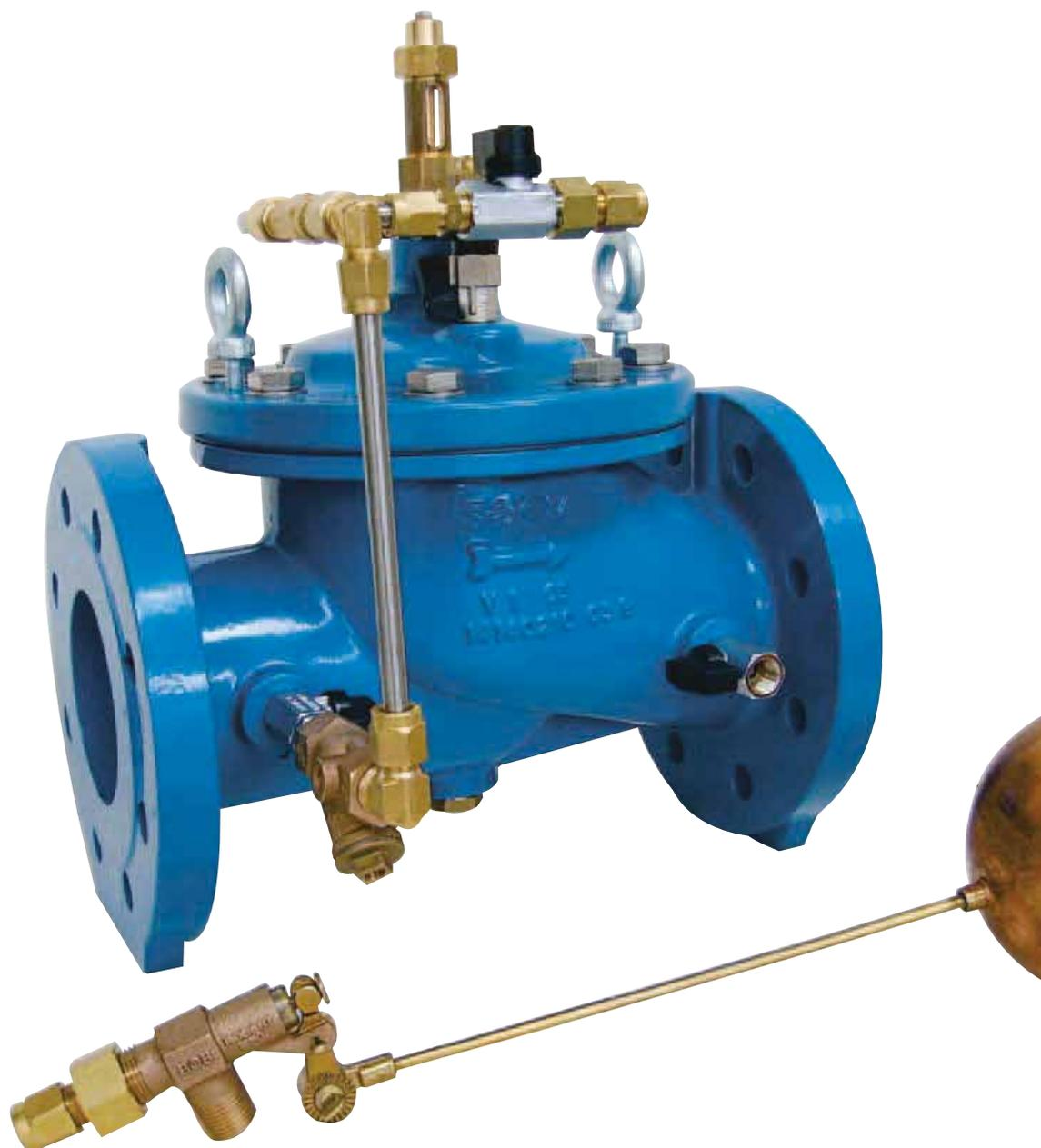
La valvola di regolazione C 701 evita la tracimazione e mantiene costante il livello dei serbatoi mediante una valvola a galleggiante. L'apertura e la chiusura sono graduali, nell'ordine di pochi centimetri dal livello desiderato.
