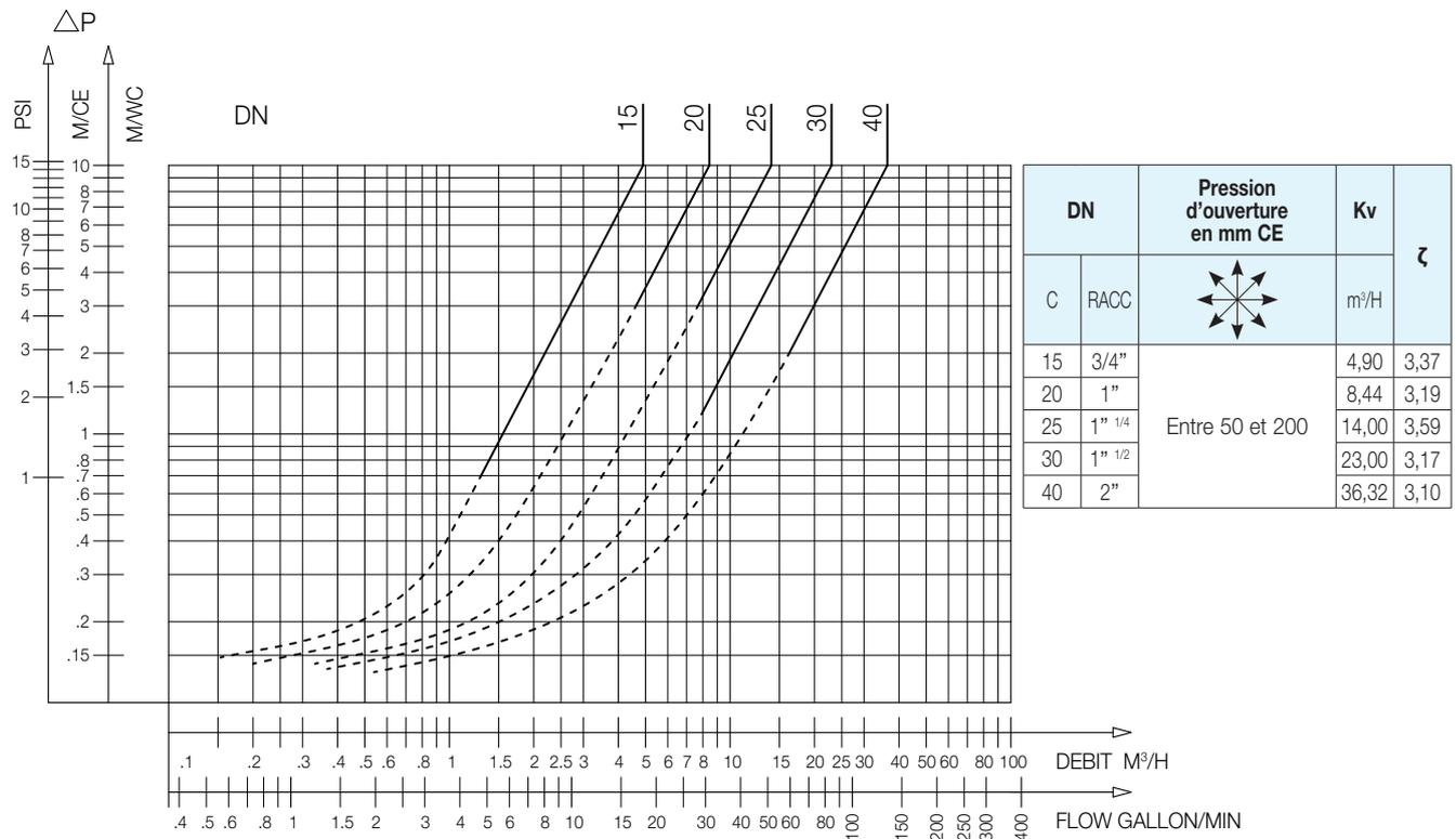
EA 251PU - Abaque des pertes de charge
